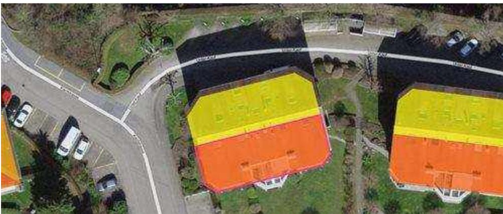
Abbildung 3 Darstellung Solarpotenzial (dunkelrot hervorragend, orange sehr gut, hellorange gut, gelb mittel und blau gering)
